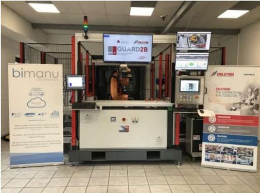
Abbildung 1: Testmaschine von Wichelhaus: Die modulare Anlage verfügt über zehn Stationen, die von einem Industrieroboter bedient werden. Für verschiedene Programme und Stationen erfolgt eine vollautomatisierte Umrüstung.
